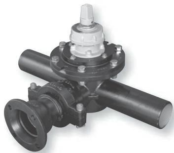
コスモ3Dバルブ新設用は、新設配管時に設ける三方弁で、バルブ操作で通水方向を任意に切換えることができ、既設配管との連絡弁に適しています。
