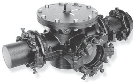
既設管の所定位置に独自で開発した弁体を挿入・設置することにより、管路の仮設・移設・切り廻し工事が敏速に施工出来ます。分岐位置を既設管と同じ高さに配置し、既設管上面から製品上部までの高さを低く押さえていますので浅層埋設管路に最適です。分岐側を閉止状態にして弁体を挿入し設置工事を完了させ、移設・新設管路等完了後、弁体の操作により支障管側閉止、または再度分岐管側閉止など通水方向の切換えを可能とした製品です。
