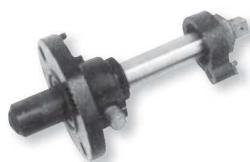
既設管の所定位置にコスマバルブST型を取り付け、インサーティング工法により、プラグST型を挿入し止水します。
