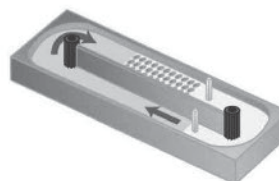
二点DO制御システム
